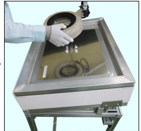
〈LED点灯&目視確認〉
